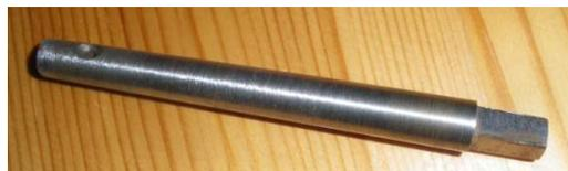
On peut faire ses chevilles soi-même, dans de la goupille conique acier ou laiton (si on en trouve !) de 7×70 mm ou 7×80mm. Il faut limer l'extrémité en carré, puis faire un trou de 2 mm à l'autre extrémité, en alésant le trou. Bien limer pour ne pas que le bord soit coupant. Les cordes n'aimeraient pas !
