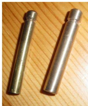
Ce sont des petites tiges de laiton de 4, 5 et 6 mm de diamètre, et environ 4 cm de longueur. Là encore, on peut les fabriquer soi-même. J'utilise ma perceuse comme un tour, en la serrant dans l'étau. Je mets chaque morceau de laiton coupé dans le mandrin, et avec un tiers-point, je lime une gorge à 5 mm du bord. Je lime également les deux extrémités.
