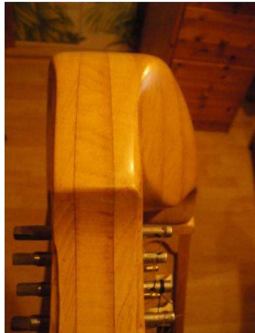
La déviation moyenne est de 2 cm environ, c'est-à-dire que le bord gauche de la console (par rapport au harpiste jouant) se trouve centré sur le chevalet. Dès lors, l'ajustage est un peu délicat, car la crosse doit s'adapter parfaitement
